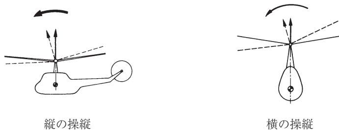
図1-7 シングル・ロータ式の縦と横の操縦
