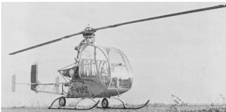
図 1-5 翼端駆動式 (シュド・ジン)
