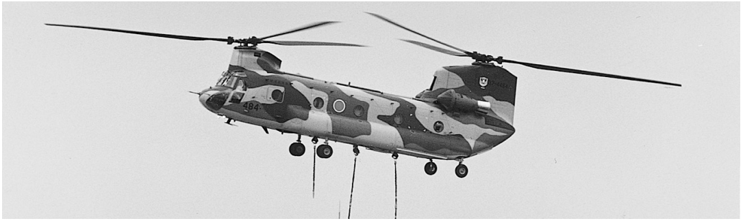
図 1-10 タンデム・ロータ式 (CH-47)
