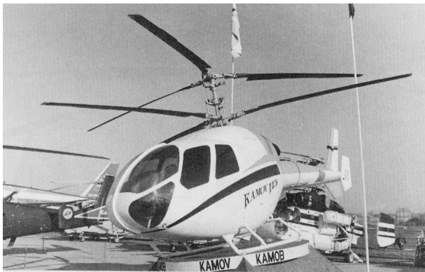
図 1-8 同軸反転ロータ式 (カモフ Ka-115)
