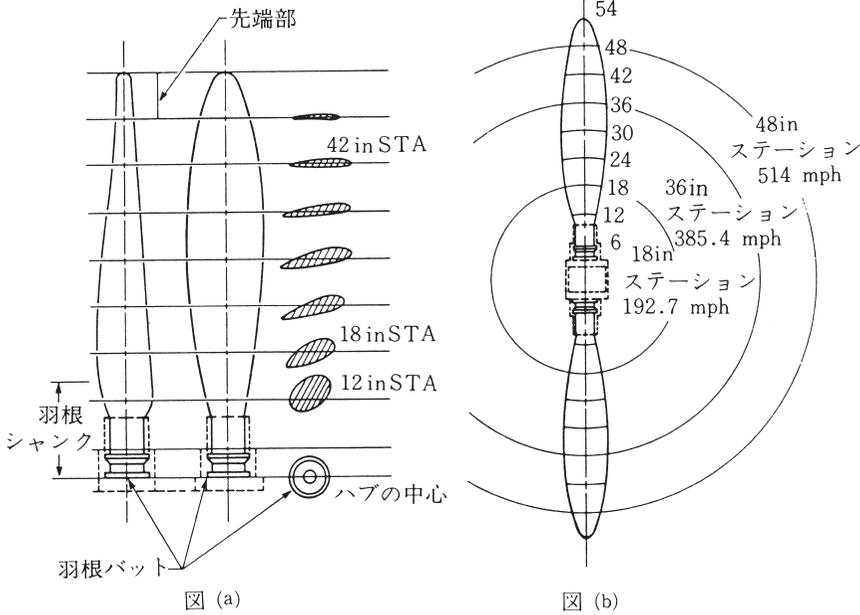
図 1-6 1,800 rpm 時のステーションの速度とピッチ分布
