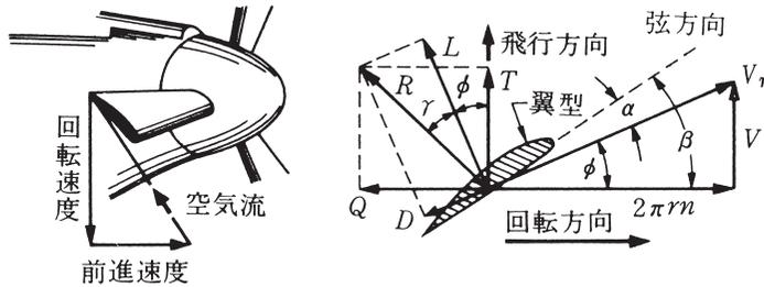
図 1-7 プロペラ断面 (半径  $r$ ) のベクトル
